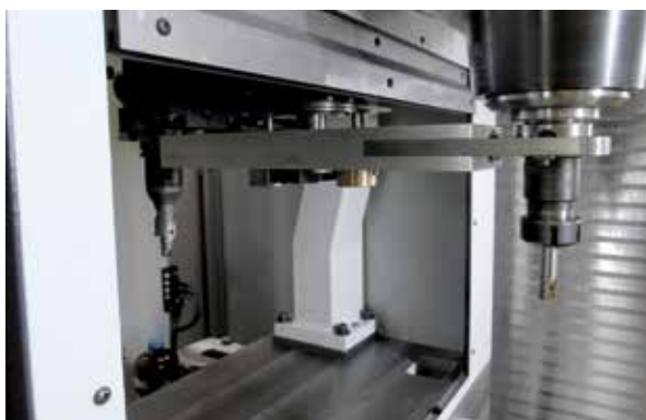
■ Braccio cambio utensili. Tool change Arm.
