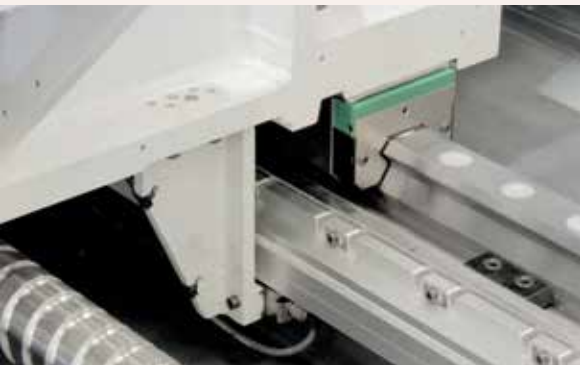
■ Guide Rulli Taglia 55 mm. Roll Ways Size 55 mm.
